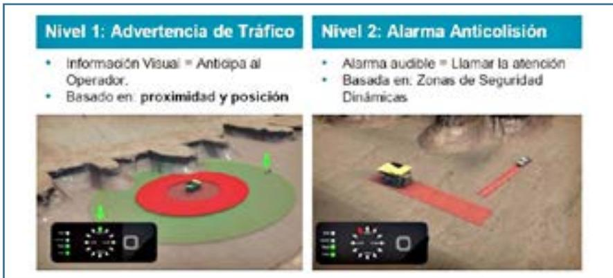
Figura 6: Alarmas de Proximidad y Posición en Cabina-Rajo Abierto (rojo-verde)
