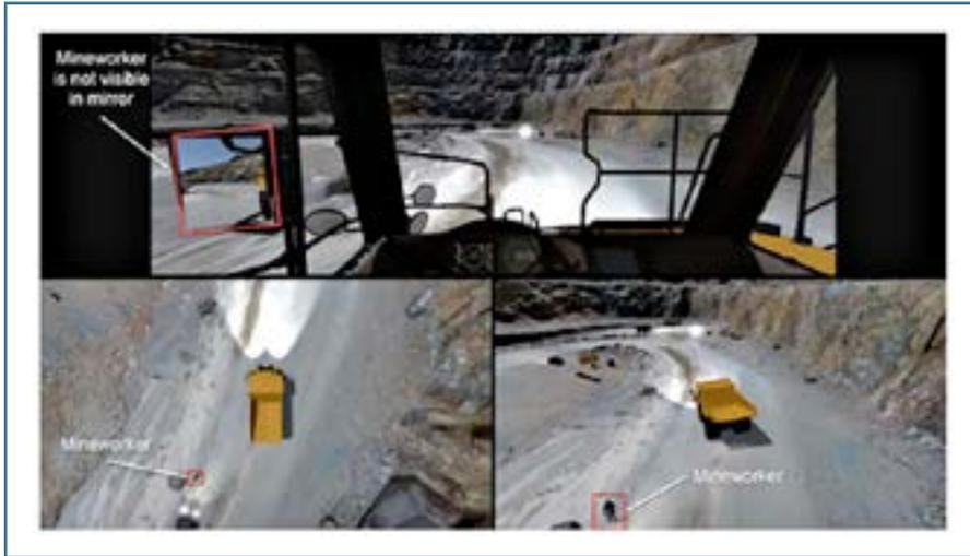
Figura 1: Prueba Línea Vista desde La Cabina de un CAEX
